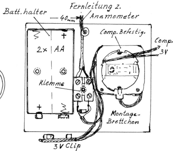
**1.** Ca. 40mm seitlich an der Hinterkante des Montagebrettchens eine kleine Rille für das Anemometerkabel einsägen oder feilen. (Mit der Schraube plus Beilagscheibe wird am Schluss das zum anemometerführende Kabel geklemmt). Das Montagebrettchen an den Kanten abschleifen (Glaspapier-Feile etc.). Das Brettchen könnte man jetzt noch lackieren.
